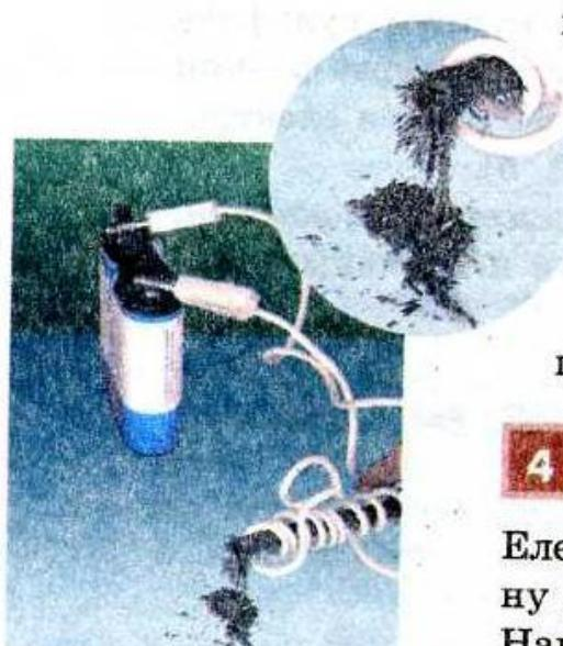
**Рис. 6.3.** Під час пропускання струму цвях стає магнітом і притягує до себе залізні ошурки
