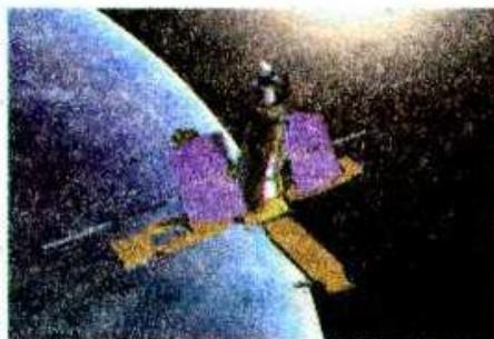
Рис. 7.3. Сонячні батареї на «Січ-1М» — супутнику дистанційного зондування Землі — здатні постачати електроенергію для всього комплексу дослідницької апаратури. Сонячні батареї перетворюють енергію світла на електричну енергію
