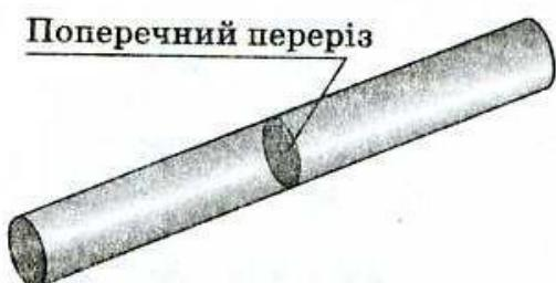
Рис. 9.1. Уявно розрізавши стрижень, одержуємо його поперечний переріз
