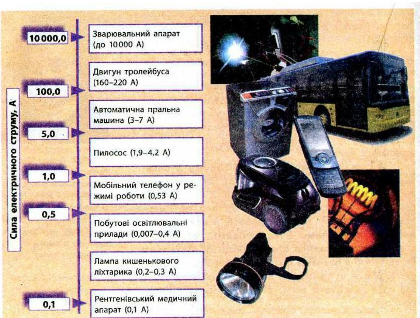
**Рис. 9.4.** Значення сили струму в деяких електротехнічних пристроях
