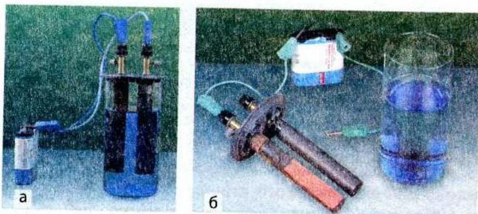
**Рис. 6.2.** Дослід, що демонструє хімічну дію електричного струму: якщо протягом деякого часу пропускати струм через водний розчин купрум сульфату (а), на одному з електродів з'явиться тонкий шар міді (б)
