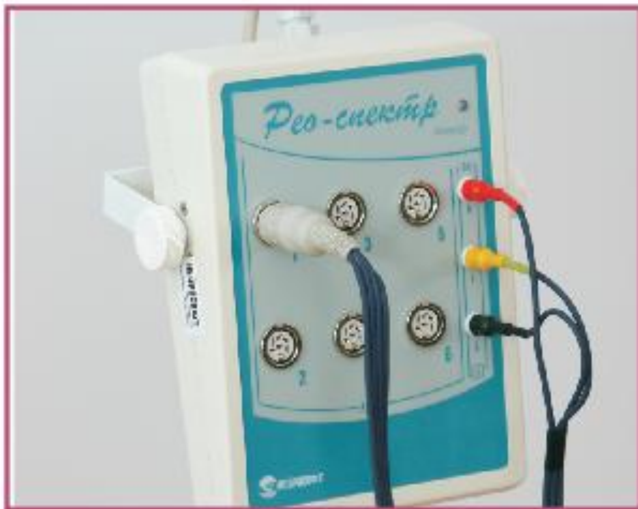
6-канальный реограф «Рео-Спектр-3» с подключенными кабелями отведений РЭГ, ЭКГ
