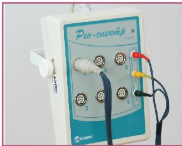
6-канальный реограф «Рео-Спектр-3» с подключенными кабелями отведений РЭГ, ЭКГ
